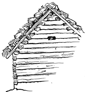
Obr. 17: Menšie hospodárske zrubové stavby bez a s povrchovou úpravou hlinenou mazanicou + zrubové klenuté stropy (zdroj: FROLEC, V., VAŘEKA, J.: Lidová architektúra-Encyklopedie, ALFA Praha, 1983. s. 208)
