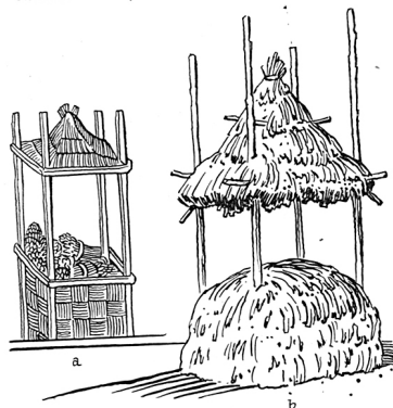
Obr. 05: Oborohy (senníky) — kolové konštrukcie s posuvnými strechami (zdroj: FROLEC, V., VAŘEKA, J.: Lidová architektúra-Encyklopedie, ALFA Praha. 1983, s. 135)
