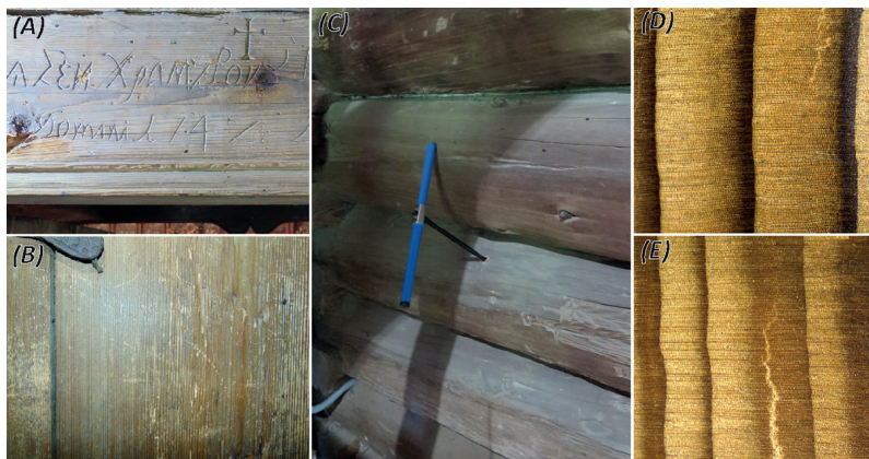
Obr. 02: Metodika odběru vzorků z historických stavebních konstrukcí zahrnuje popis konstrukce a zaznamenání nápisů na konstrukci (A) a samotný odběr vzorků pořízením fotografie (B) nebo použitím Presslerova přírůstového nebozezu (C), ideálně v místě tzv. podkorního letokruhu zakončeného buď jarním (D), nebo letním (E) dřevem.
